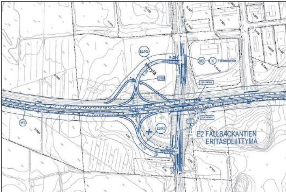
Kuva 35. Fallbackantien eritasoliittymä, tarkennettu suunnitelma.
